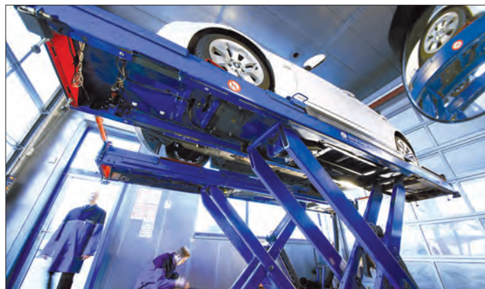
Prüfstände liefern eindeutige Ergebnisse und bieten optimale Stoßdämpfereinstellungen an allen Rädern. Werkfoto: TÜV Rheinland
